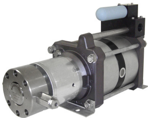
G500-2 (L)S einfachwirkend, doppelter Luftantrieb (nur lieferbar mit seitlichem Einlass)
