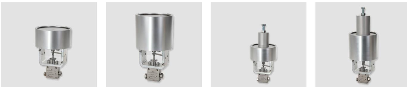
Maximator Ventilantriebe sind pneumatisch betriebene Kolbenantriebe und werden auf Standardventilkörper montiert um eine Fernsteuerung zu ermöglichen. Es sind zwei Antriebe der Wirkrichtung „Luft öffnet, Feder schließt“ und zwei Antriebe der Wirkrichtung „Luft schließt, Feder öffnet“ erhältlich. Die Auswahl basiert auf der Ventilgröße, dem Systemdruck und der verfügbaren Druckluft.
