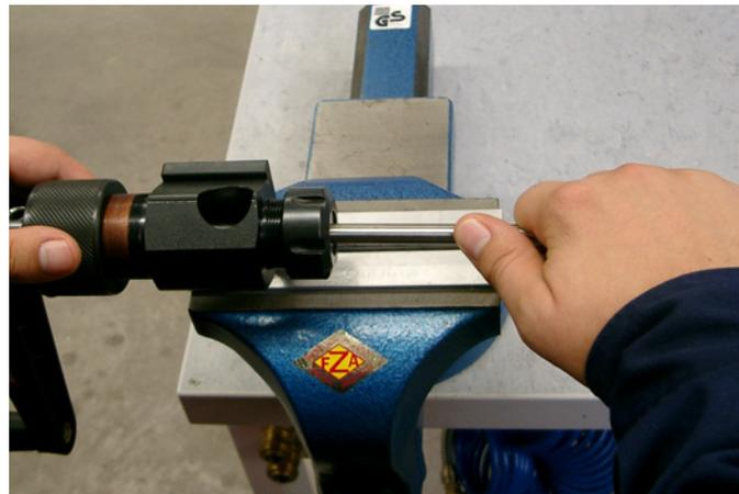
Setzen Sie das Rohr in die Spannzange ein. Nach vorne bis zur Spannzange drücken und ca. 1 mm nach hinten ziehen.
