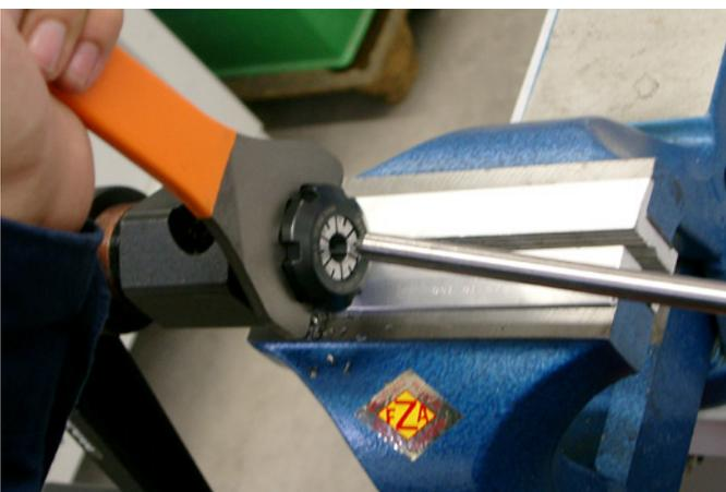
Verwenden Sie den Spanschlüssel, um die Spannmutter zu lösen, und das Rohr kann wieder aus dem Konuswerkzeug herausgezogen werden.
