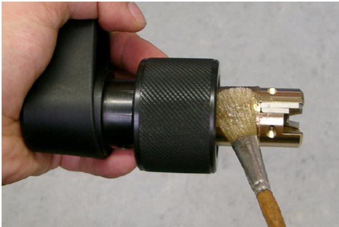
Schmieren Sie die Lauffläche des Schneidplattenhalters.
