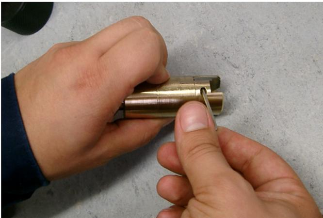
Lösen Sie die 4 Madenschrauben im Werkzeughalter, um die Schneidwerkzeuge zu demontieren. Entfernen Sie dann das Werkzeug aus dem Werkzeughalter.
