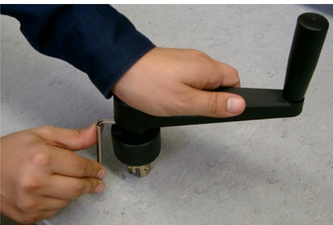
Richten Sie die Handkurbel und den Schneideisenhalter so aus, dass der Gewindestift der Handkurbel auf die Schlüsselfläche am Schaft des Schneideisenhalters drückt.
