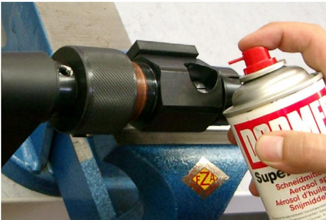
Durch die seitliche Öffnung im Grundkörper Schneidöl auf die Schneidwerkzeuge und das Rohrende auftragen. Wiederholen Sie den Vorgang mehrmals während des Schneidens.
