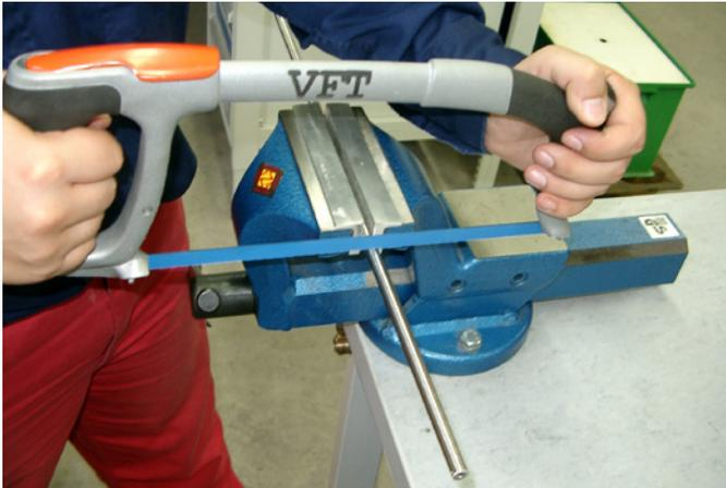
Die Rohrlänge ergibt sich aus dem Abstand der zu verbindenden Bauteile plus dem Aufmaß für jede Verbindung gemäß Tabelle 2.
