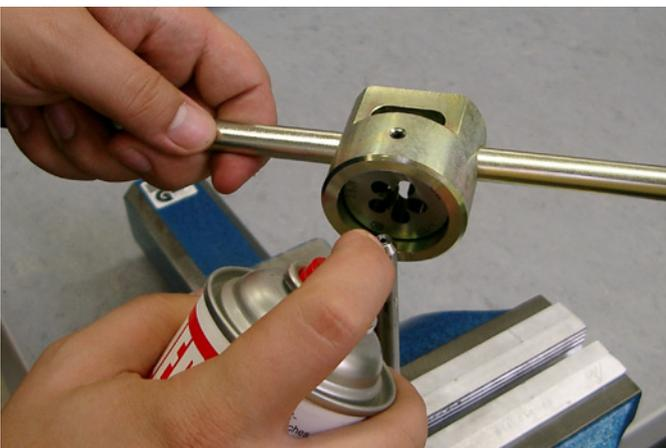
Befeuchten Sie das Rohr und die Matrize mit Schneidöl.
