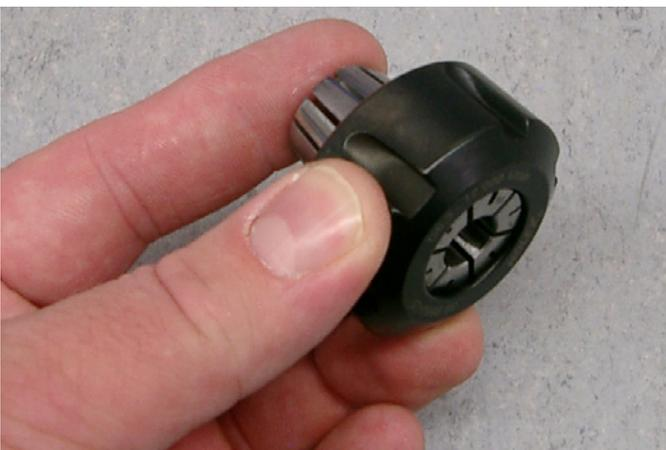
Schieben Sie die Spannzange in die Spannmutter.
